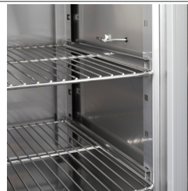
Roste mit leicht herausnehmbaren Führungen und 7 Positionen (75 mm Rastermaß)
