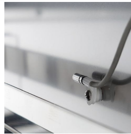
Innenfühler zur kontinuierlichen Temperaturüberwachung
