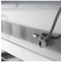
Innenfühler zur kontinuierlichen Temperaturüberwachung
