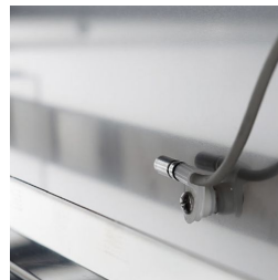
Innenfühler zur kontinuierlichen Temperaturüberwachung
