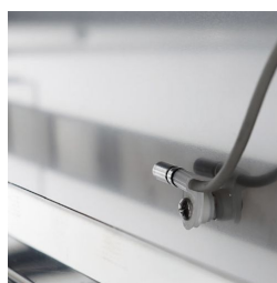
Innenfühler zur kontinuierlichen Temperaturüberwachung
