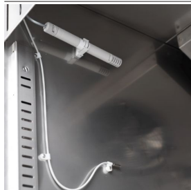
Feuchtigkeitskontrolle mit elektronischer Sonde
