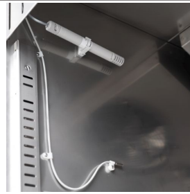
Feuchtigkeitskontrolle mit elektronischer Sonde
