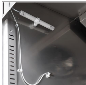
Feuchtigkeitskontrolle mit elektronischer Sonde
