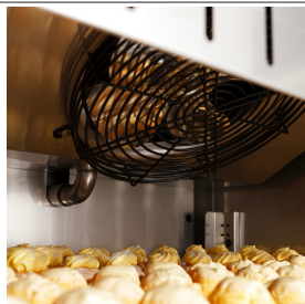
Verdampfer mit KTL-Beschichtung und elektronischen Ventilatoren
