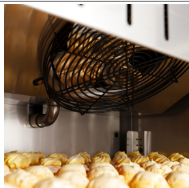
Verdampfer mit KTL-Beschichtung und elektronischen Ventilatoren
