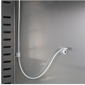
Interne Zellsonde zur konstanten Temperaturüberwachung
