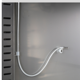
Interne Zellsonde zur konstanten Temperaturüberwachung
