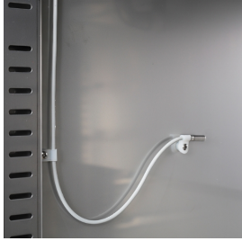
Interne Zellsonde zur konstanten Temperaturüberwachung
