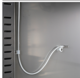
Interne Zellsonde zur konstanten Temperaturüberwachung
