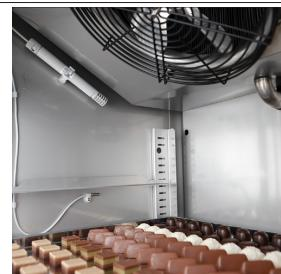
Elektronische Sonde zur Erfassung der relativen Luftfeuchtigkeit
