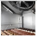
Elektronische Sonde zur Erfassung der relativen Luftfeuchtigkeit
