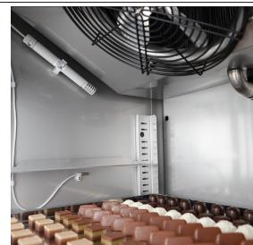
Elektronische Sonde zur Erfassung der relativen Luftfeuchtigkeit
