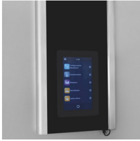
Vollständig kundenspezifische 7" GEMM-Touchscreen-Schnittstelle
