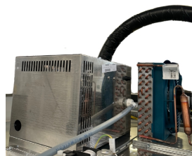
Hocheffizienter Dampfkessel (Dampfzeugung von 2-2,6 kg/h)
