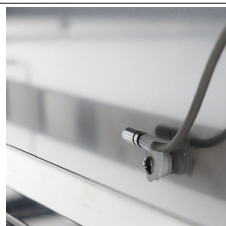
Sonde intérieure de cellule pour le contrôle constant de la température
