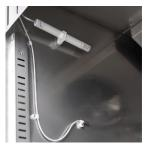
Contrôle de l'humidité avec une sonde électronique
