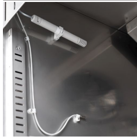
Contrôle de l'humidité avec une sonde électronique
