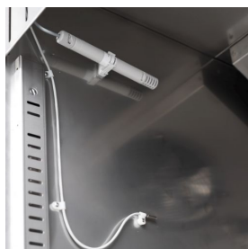
Contrôle de l'humidité avec une sonde électronique
