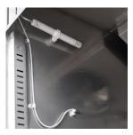
Contrôle de l'humidité avec une sonde électronique
