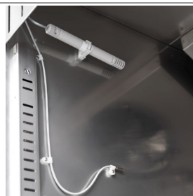
Contrôle de l'humidité avec une sonde électronique
