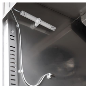
Contrôle de l'humidité avec une sonde électronique
