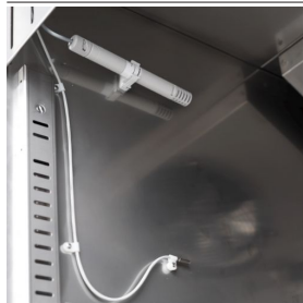
Contrôle de l'humidité avec une sonde électronique
