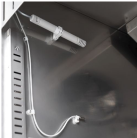
Contrôle de l'humidité avec une sonde électronique
