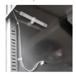
Contrôle de l'humidité avec une sonde électronique
