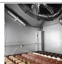
Sonde électronique pour la détection de l'humidité relative
