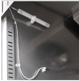
Contrôle de l'humidité avec une sonde électronique
