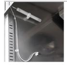
Contrôle de l'humidité avec une sonde électronique
