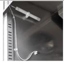
Contrôle de l'humidité avec une sonde électronique
