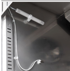
Contrôle de l'humidité avec une sonde électronique
