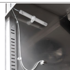
Contrôle de l'humidité avec une sonde électronique
