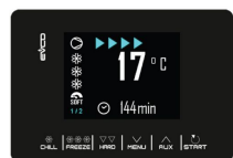
Carte électronique tactile 2,8" avec affichage numérique
