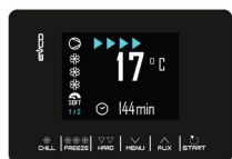
Carte électronique tactile 2,8" avec affichage numérique
