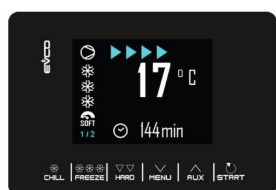
Carte électronique tactile 2,8" avec affichage numérique
