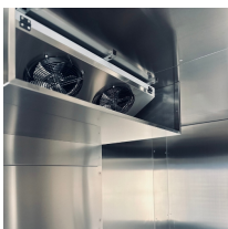
Ventilateurs électroniques qui optimisent la ventilation à chaque étape
