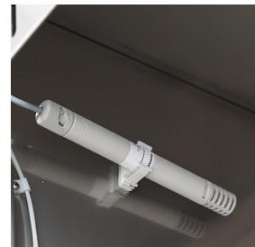
Kit per il controllo dell'umidità in cella con sonda elettronica per la rilevazione dell'umidità relativa
