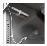
Controllo dell'umidità con sonda elettronica
