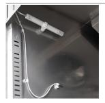
Controllo dell'umidità con sonda elettronica
