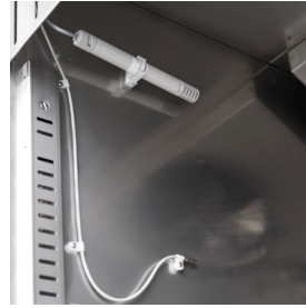
Controllo dell'umidità con sonda elettronica
