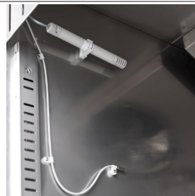
Controllo dell'umidità con sonda elettronica
