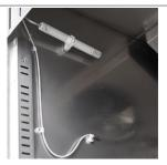
Controllo dell'umidità con sonda elettronica
