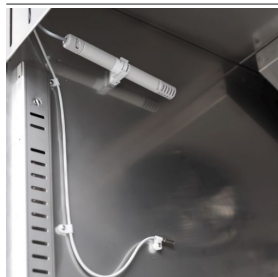
Controllo dell'umidità con sonda elettronica
