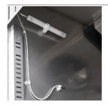
Controllo dell'umidità con sonda elettronica
