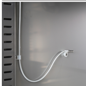
Sonda interno cella per il controllo costante della temperatura
