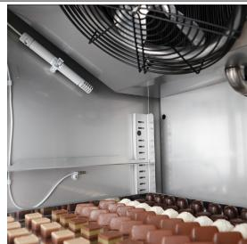
Sonda elettronica per la rilevazione della umidità relativa
