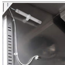
Controllo dell'umidità con sonda elettronica
