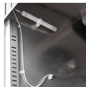
Controllo dell'umidità con sonda elettronica
