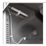
Controllo dell'umidità con sonda elettronica
