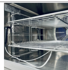
Dettaglio ventilazione interna
