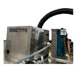
Caldaia vapore ad alta efficienza (produzione vapore da 2-2,6 kg/h)
