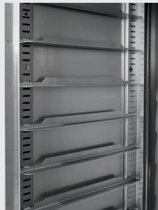
Cremagliere con guide facilmente rimovibili con 74 posizioni (passo mm 16,5). Crémaillères avec glissières facilement démontables à 74 positions (pas de 16,5 mm). Cremallera con guías fácilmente desmontables con 74 posiciones (paso mm 16,5).
